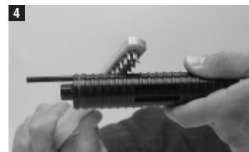
4 Exterior del guía-pistón
