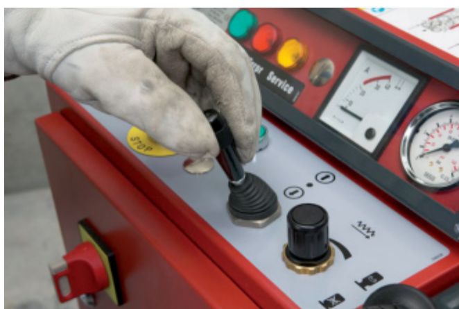
Ovládání ventilu posuvu vpřed (DS WS10-E)
