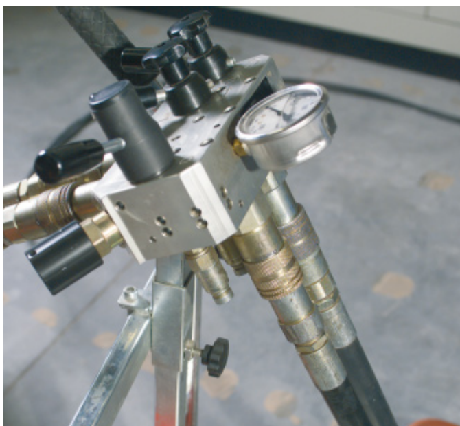
Připojení hydraulických hadic k hydraulické dálkové obsluze nebo k agregátu (D-LP15 / D-RC22 s D-LP32).
