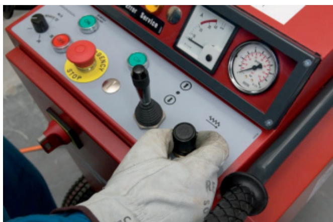
Nastavení tlaku pro posuv vpřed (DS WS10-E).
