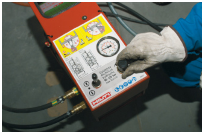
Nastavení tlaku pro posuv vpřed (DS WS10).
