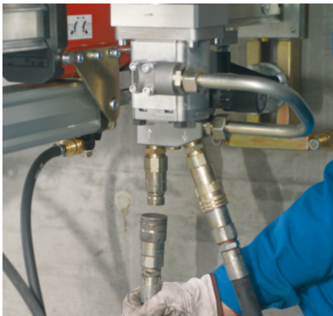
Připojení hydraulických hadic k pohonné jednotce - hydromotoru (DS WS10)
