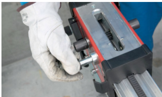
Z vodícího krytu vysuňte svěrací čepy
