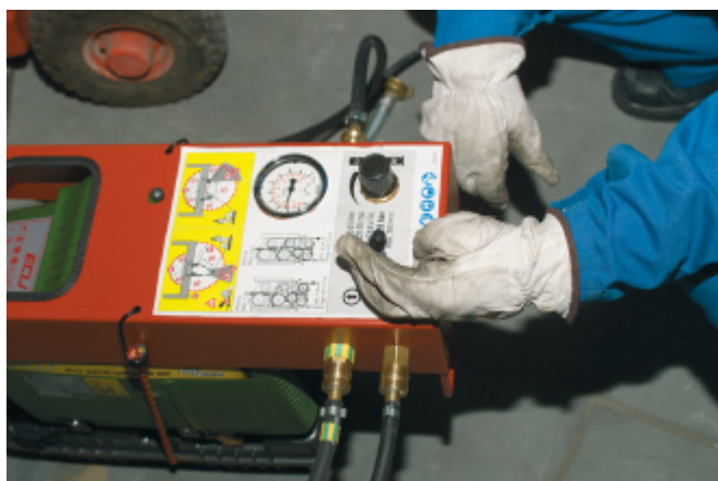
Ovládání ventilu posuvu vpřed (DS WS10).
