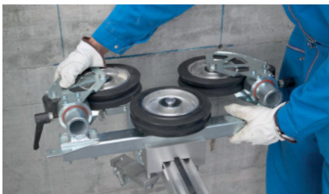
Upínací hák pohonné jednotky zasuňte do drážky vedení.
