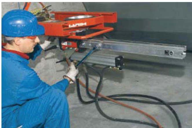
Nasad'te zostavu rozširujúcu zásobu lana a zaistite excentrickými čapmi.
