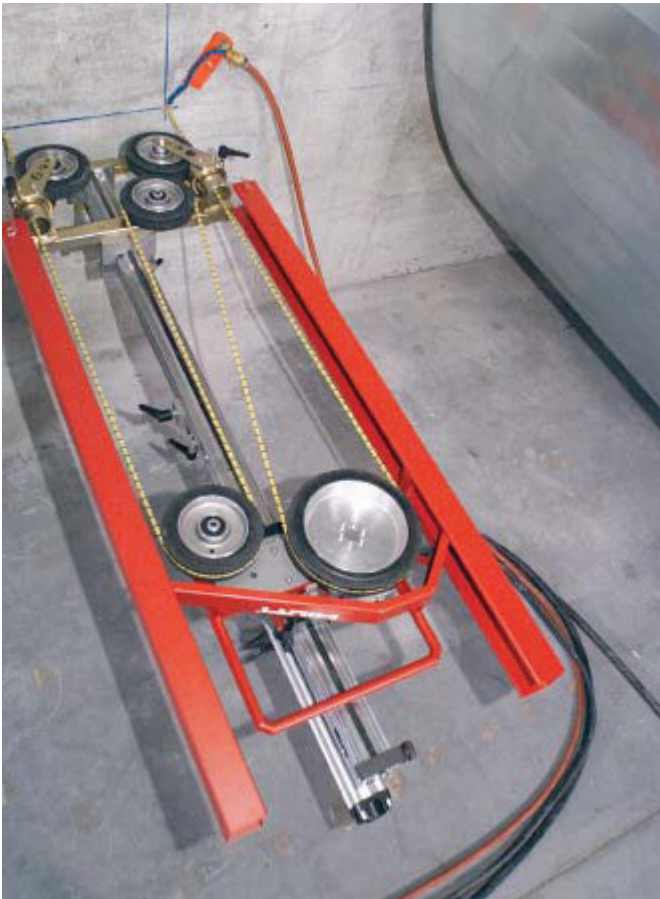
Pripojenie prívodu stlačeného vzduchu k valcu.
