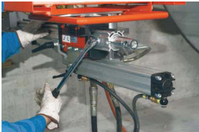
Zasuňte spojovací kužel a zovrite excentrickým čapom.
