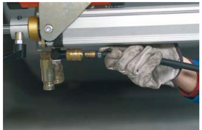
Pripojenie prívodu stlačeného vzduchu k valcu.
